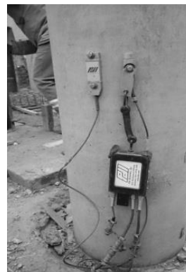
Figura 1. Sensores do PDA instalados no fuste da estaca
